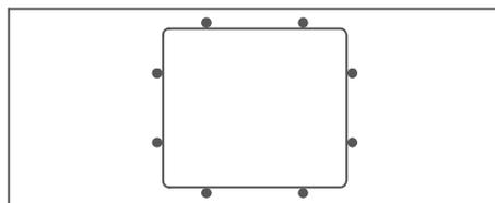
indicare sempre larghezza e profondità del foro grezzo e dello scavo raggio interno ed esterno, le misure sono ricavabili dalla scheda tecnica dell' elettrodomestico. N.B. i fori a filo top devono essere realizzati con le tolleranze indicate dai marchi produttori.
