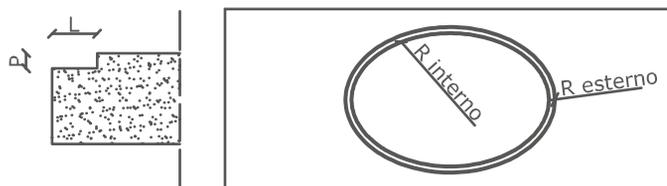
indicare sempre larghezza e profondità del foro grezzo e dello scavo raggio interno ed esterno, le misure sono ricavabili dalla scheda tecnica dell' elettrodomestico. N.B. i fori a filo top devono essere realizzati con le tolleranze indicate dai marchi produttori.
