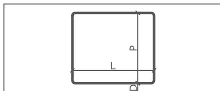
Le posizioni nel disegno sono puramente indicative. Indicare sempre la collocazione delle bussole facendo riferimento alla disegno tecnico del lavello. Fare particolare attenzione che la bussola non ostacoli l'armatura dei mobili sottostanti.
