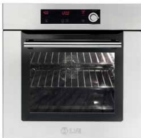
Il forno 600 ha la funzione di pirolisi, un sistema di pulizia automatica che sfrutta il calore del forno. Regolando la pirolisi, la temperatura interna raggiunge circa 470° C, bruciando tutti i residui di cottura che si sono depositati sulle pareti interne del forno e della porta.
