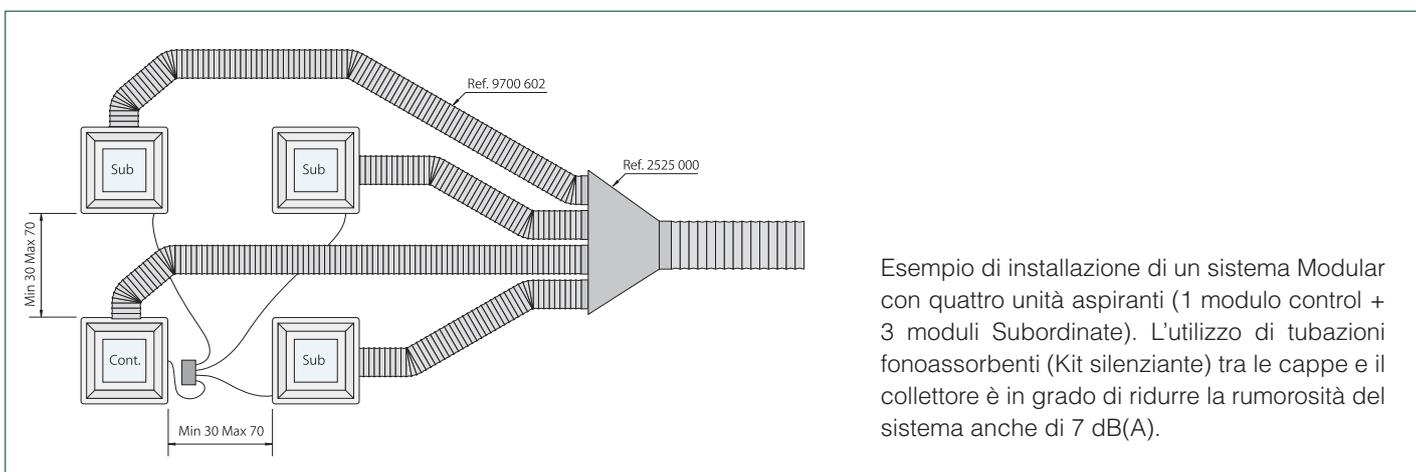
Esempio di installazione di un sistema Modular con quattro unità aspiranti (1 modulo control + 3 moduli Subordinate). L'utilizzo di tubazioni fonoassorbenti (Kit silenziate) tra le cappe e il collettore è in grado di ridurre la rumorosità del sistema anche di 7 dB(A).
