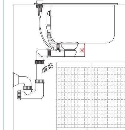
**Pensato per vasche profonde, Space ha un ingombro molto contenuto.** Nel disegno è presentata la vista laterale del sistema Space. L'altezza ridotta della piletta e la conformazione del sifone ottimizzano l'area sotto-lavello lasciando lo spazio necessario per le esigenze di raccolta differenziata.
