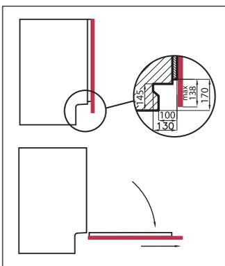
Il kit consente di installare correttamente la lavastoviglie anche in cucine con zoccolo di altezza ridotta. Il sistema Slide Door infatti determina lo slittamento dell'anta sulla porta della lavastoviglie, e **permette l'installazione di ante fino a 780 mm di altezza.**
