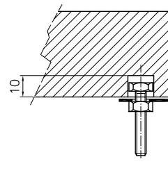
Modalità di fissaggio con vite e dado per vasche con bordo dotato di fori per l'installazione (serie Quadra).
