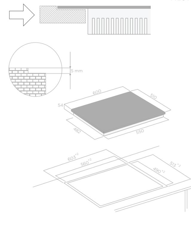
STANDARD senza cornice, con vetro in appoggio diretto sul piano di lavoro; without frame, with glass laid on the working plan/top
