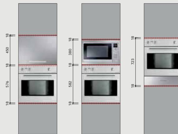
Forno da 60 + porta per vano forno a microonde
