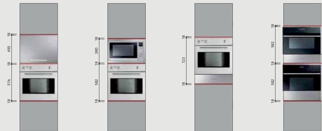
Forno da 60 + porta per vano forno a microonde
