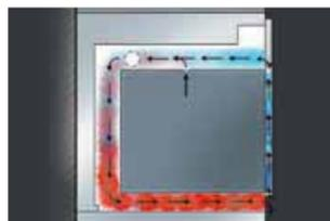
Mantiene le temperature esterne entro i limiti stabiliti dalle norme di sicurezza. All'accensione del forno entra in funzione, fino a dopo lo spegnimento, una ventola di ventilazione tangenziale che normalizza la temperatura producendo un flusso d'aria fredda.
