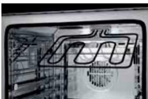
Nei forni da 60, essendo reclinabile, agevola le operazioni di pulitura della superficie superiore della cavità. (\*)
