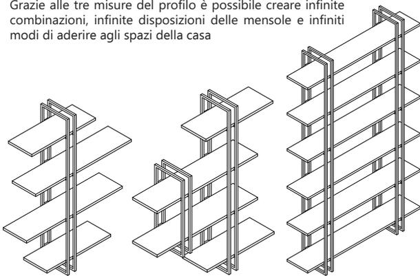
Struttura SHELL profondità 24,5 cm **sezione struttura 1,5 x 1,5 cm**
